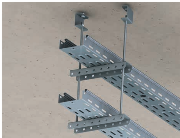
За допомогою шпильки і планки перфорованої на один або два рівня до стелі.
